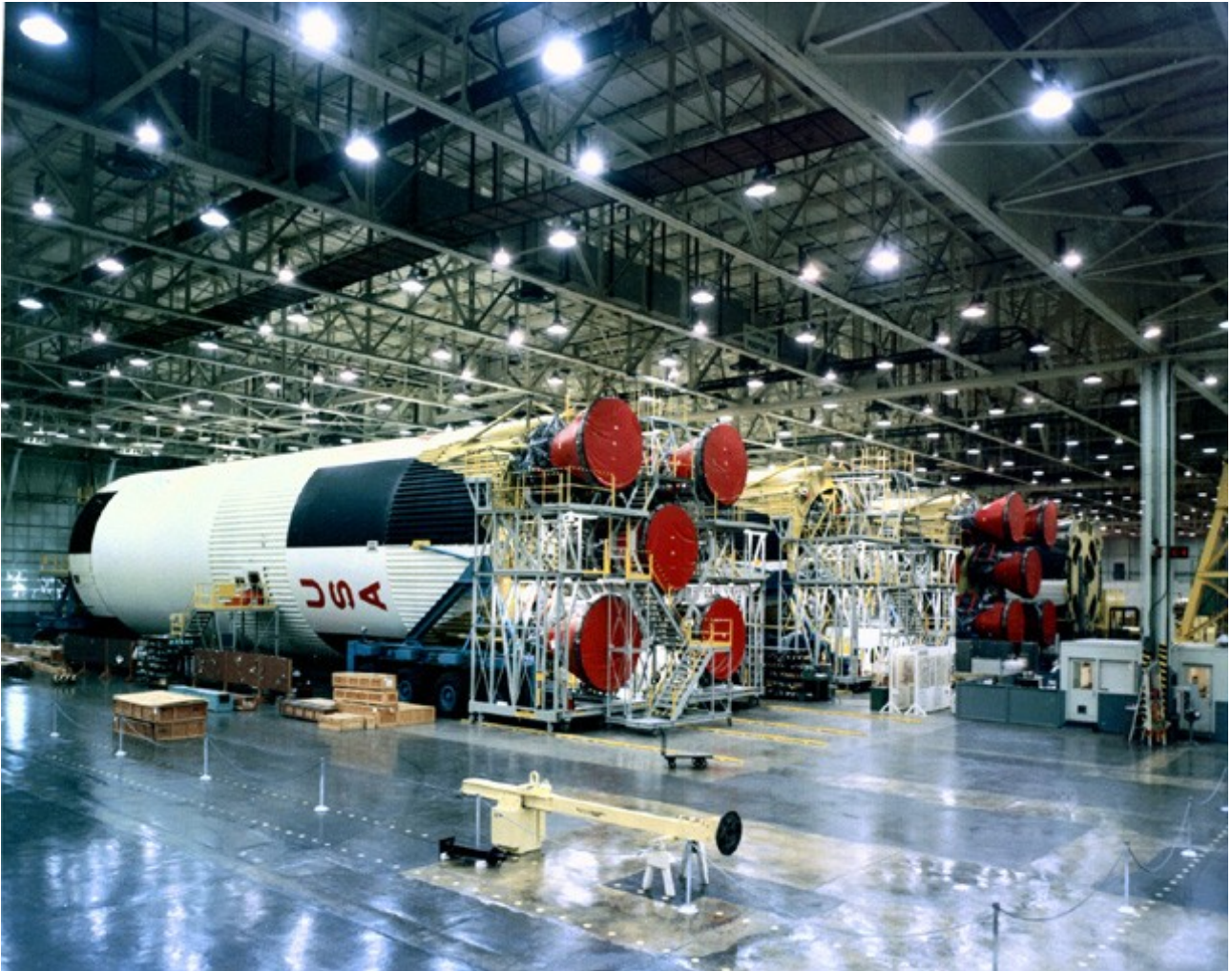
Fig.2 Vari stadi S-1C ("booster") in fase di assemblaggio - NASA
