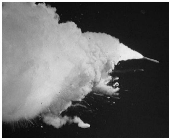
La telemetria indico' che i motori dello Shuttle si spensero automaticamente a T +73.6 secondi; l'ultima trasmissione di dati dal Challenger avvenne a T +73.618 secondi.
