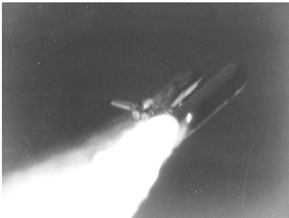
T +62 secondi - la telemetria segnala che il sistema di controllo d'assetto dello Shuttle comincia a correggere la traiettoria per tenere conto delle nuove forze che si sono venute a creare dallo scarico asimmetrico di gas incandescente dal razzo di destra. A T +64.66 secondi il serbatoio dell'idrogeno liquido dell'ET inizia a perdere pressione, segno che l'involucro e' stato perforato dall'azione tipo "fiamma ossidrica" del gas sfuggito dal vicino SRB.
