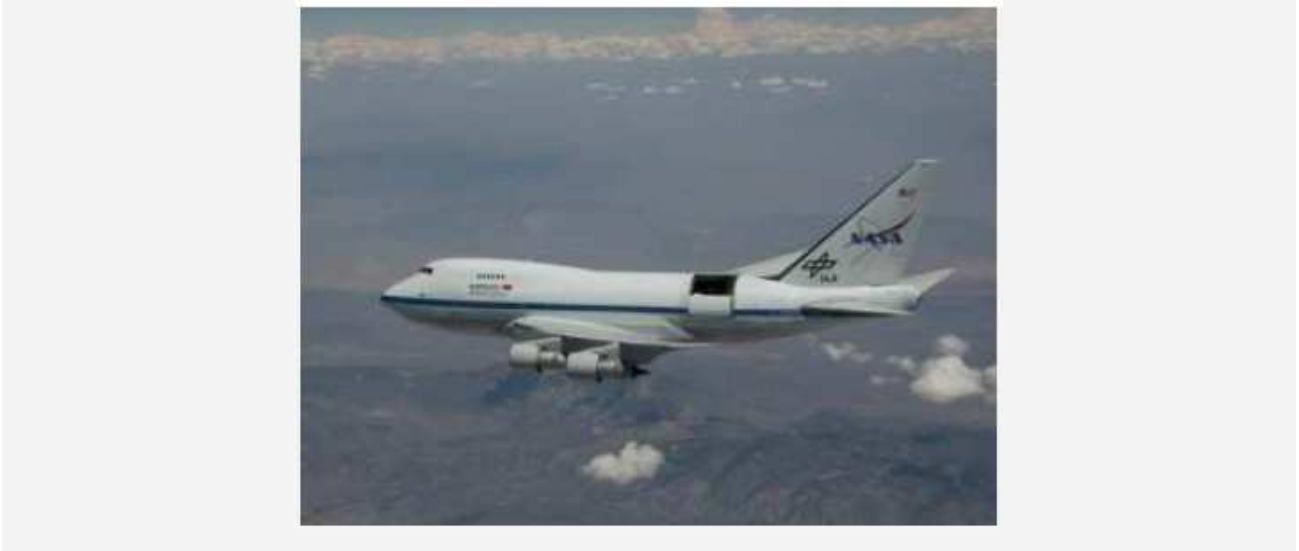
Il Boeing 747 con il vano che ospita il telescopio nell'infrarosso SOFIA aperto, a oltre 12000 metri di quota, durante gli ultimi test prima dell'entrata in servizio (Foto NASA / Jim Ross).
