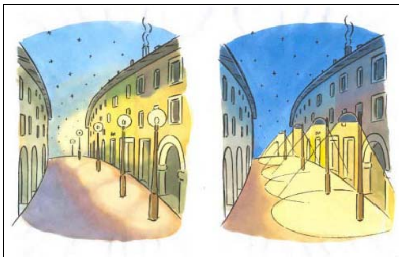
Figura 4-1: rappresentazione della stessa via illuminata da armature non schermate (a sx) e da armature totalmente schermate (a dx)
