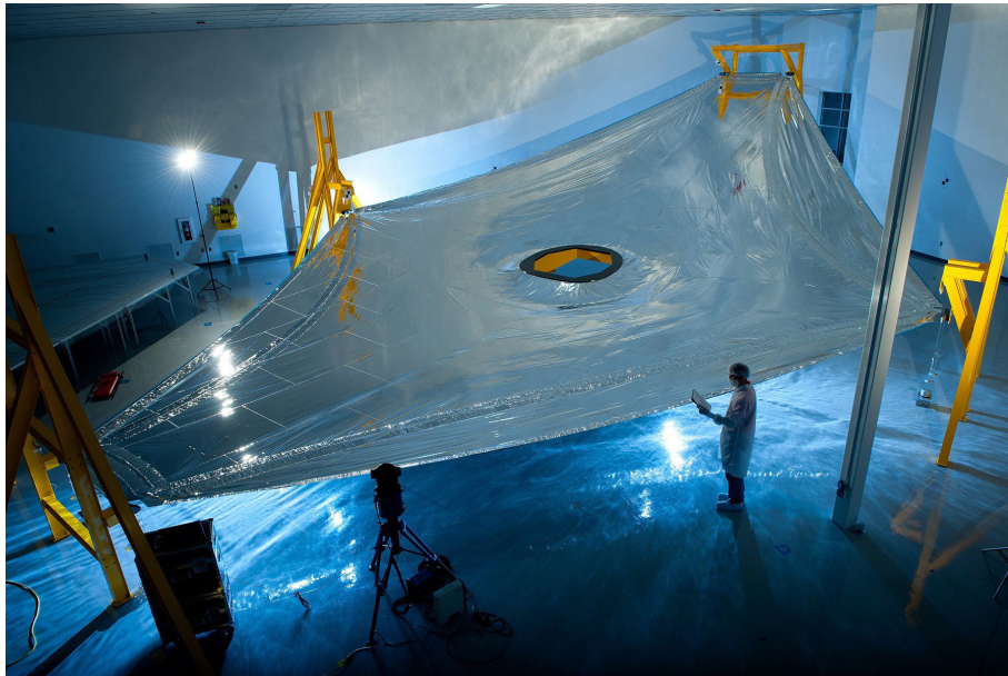
Figura 3.7: Sunshield durante la fase di test presso la “ ManTech International Corp.’s Nexolve facility ” ad Huntsville, Alabama USA.
