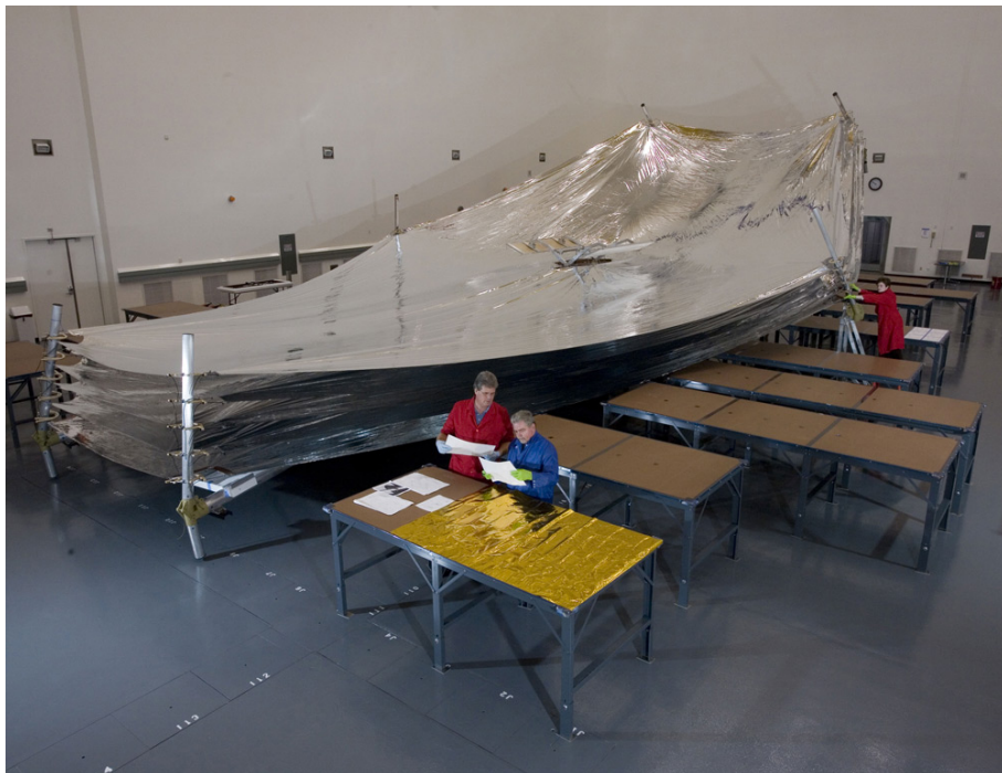
Figura 3.8: I 5 sunshields durante la fase di test.
