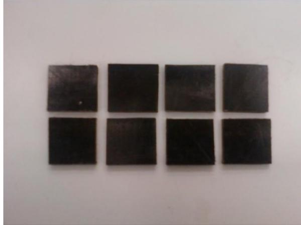
Fig. 3.5 – Campioni di PPO semplice usati durante la sperimentazione
