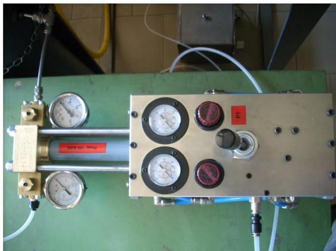
Fig. 3.3 – Booster pneumatico utilizzato per innalzare la pressione
