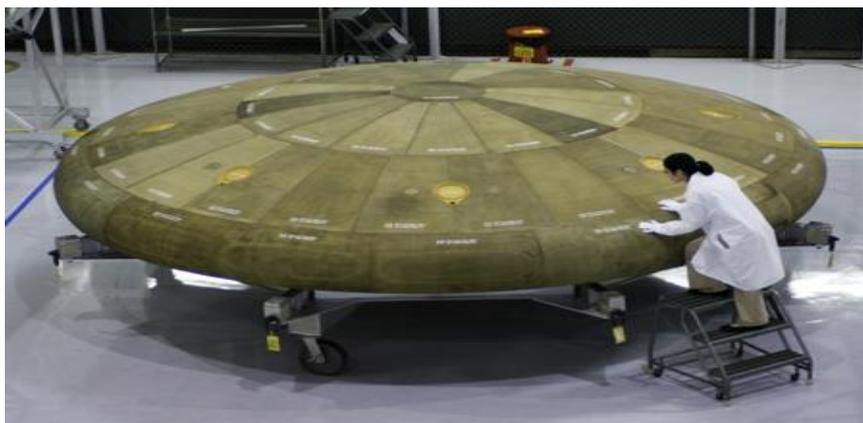
Fig. 1.10 – TPS del modulo *Orion*
