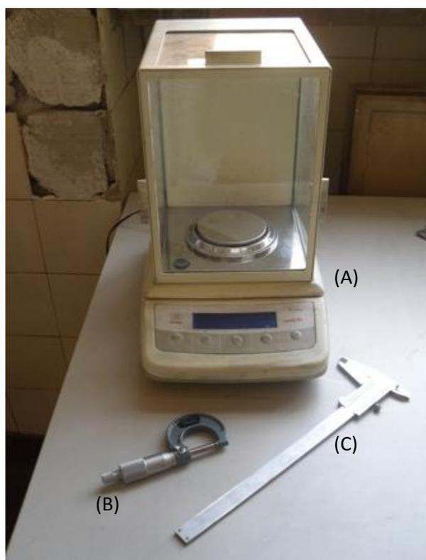
Fig. 3.2 – Bilancia di precisione (A), calibro (B) e micrometro (C) utilizzati per le misurazioni
