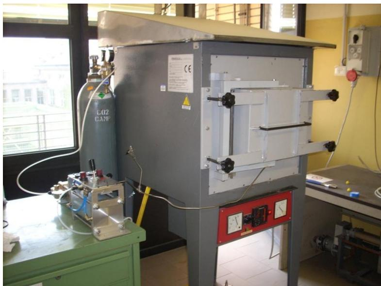
Fig. 3.6 – Forno (montato in differente configurazione) utilizzato per il processo di espansione
