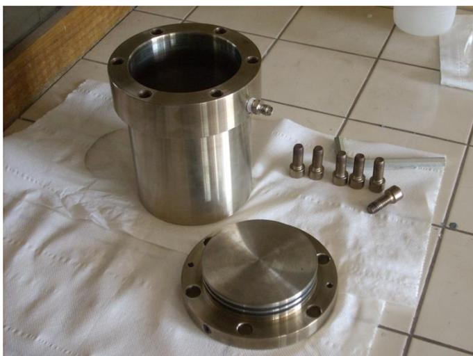
Fig. 3.4 – Camera a pressione a tenuta stagna all'interno della quale sono state create le condizioni operative
